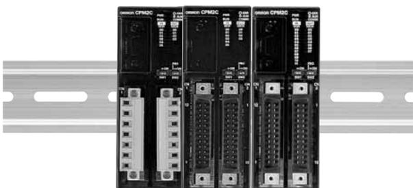
在超小型的外表下集合了有效控制机器的多彩的功能。CPU具有继电器输出/晶体管输出、端子台链接器连接、时钟功能有无等多种型号(仅限DC电源)。可根据现场情况选择输出类型、I/O点数。另外,通用8点/10点/16点/20点/24点/32点的扩展I/O单元,最多可控制192点输入输出。
