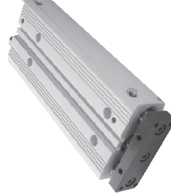
货号No. 060501 规格 06YL20-M-150 总行程：150mm 总重量：210g ※可安装限位传感器。
